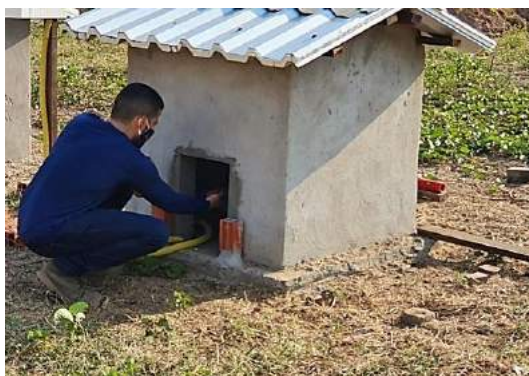
Figura 10 - Medição do ruído no protótipo constituído pelo isopor.
