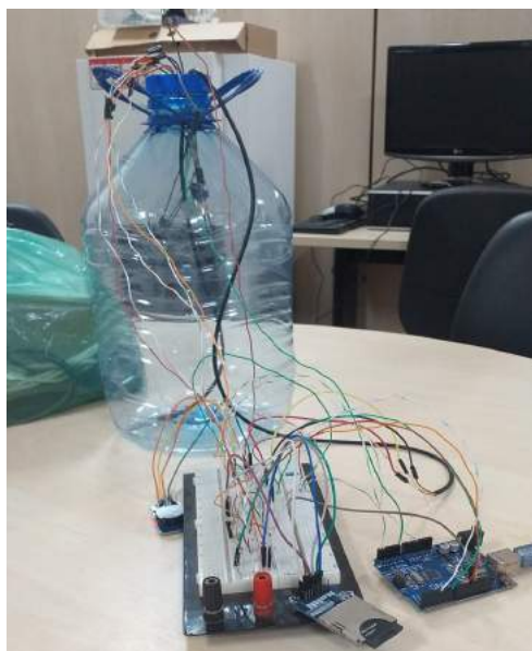
Figura 4 - Biodigestor e protoboard montada com os circuitos elétricos
