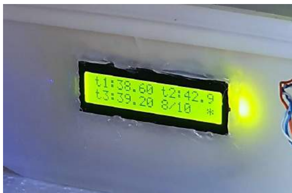
Figura 7 - Display que exhibe os dados de temperaturas e umidades.
