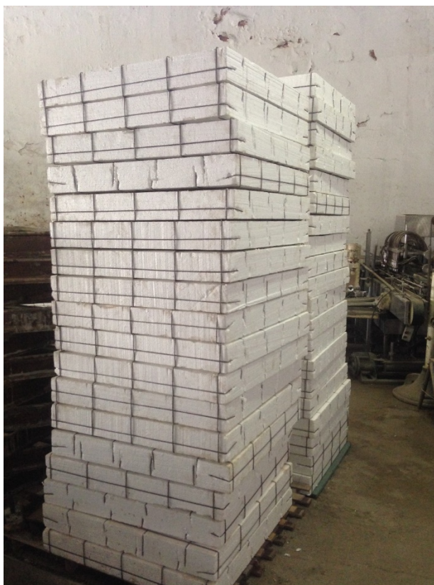
Figura 2 – Envolvimento da armadura no EPS
