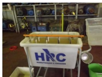
Assim, as luvas são suspensas por um condutor isolante como exemplos prendedores dentro de um recipiente com água para maior condutividade da tensão devendo elas ficarem cerca de 5 cm fora da água presa através desses prendedores isolantes, que são fixados a um bastão isolante, como mostrado nas Figuras 4 e 5.
