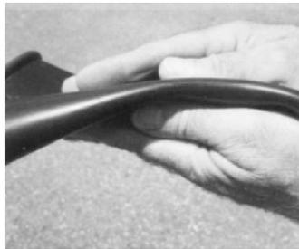
Figura 2 - Testes em campo para detectar furos na luva
