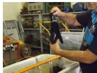
As mangas isolantes são confeccionadas em borracha natural podendo ou não ser halogenadas. O processo de halogenação faz com que a manga se torne mais agradável ao tato. Podem ser divididas em cinco classes de isolamento e em dois tipos.
