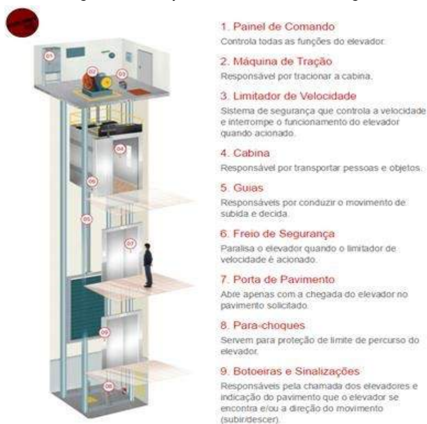
Figura 12 - Conjuntos do elevador de carga
