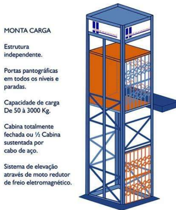
Figura 10 - Elementos de um elevador de carga
