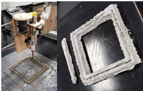
Figura 6 – Extrusora de trabalho (esquerda) e duas peças impressas com argamassa (direita)
