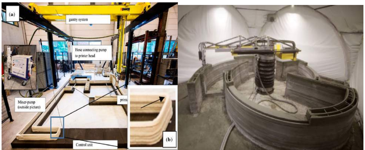
Figura 2 – Sistema de pórtico (esquerda) e sistema robótico cilíndrico (direita) na impressão 3D para construção
